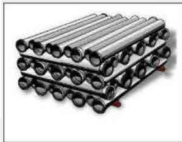
Fig. 05. Armazenagem em leitos superpostos, com camadas perpendiculares
