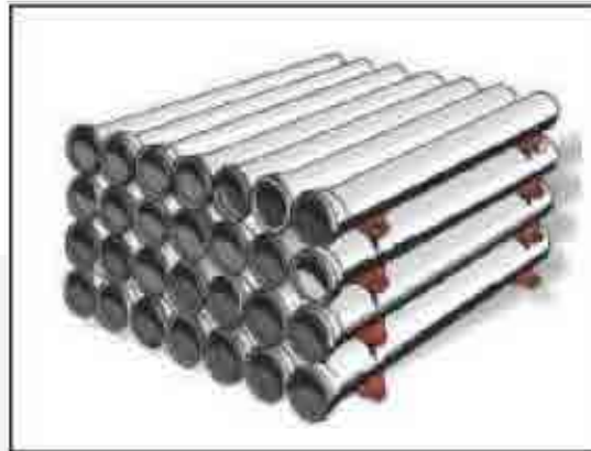
Fig. 04. Armazenagem em leitos superpostos, com bolsas no mesmo sentido.
