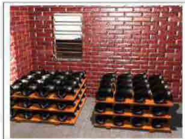
Fig. 06. Armazenagem de conexões em ferro fundido
