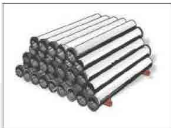
Fig. 03. Armazenagem em leitos superpostos, com bolsas em sentidos alternados.
